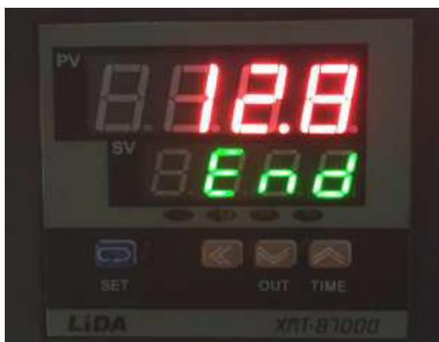
**Рис. 7 Автоматический таймер с сигнализацией времени**
