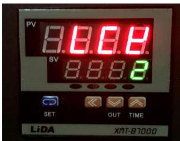
**Рис. 6. Установка параметра термоконтроллера LC** **ℙ**
