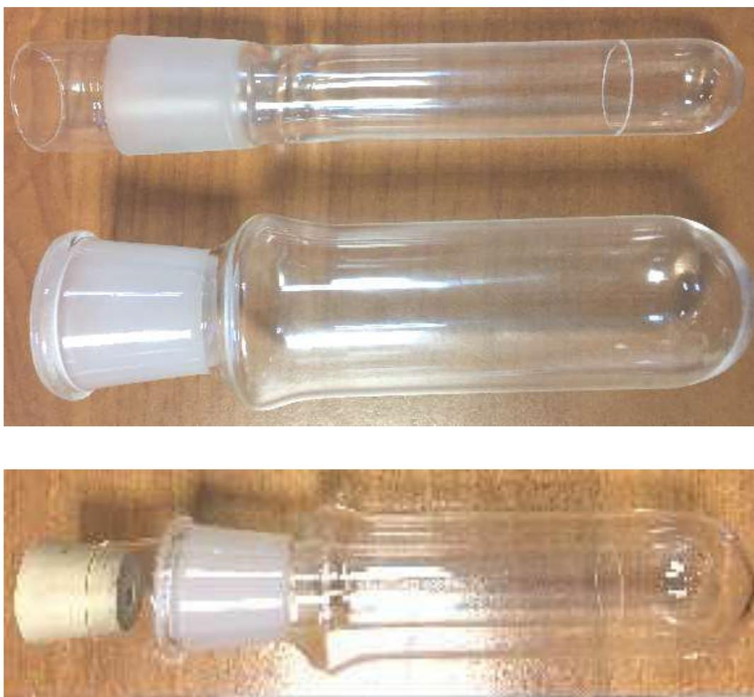
**Рис.9. Комплект пробирок по отдельности и в сборе с пробкой**
