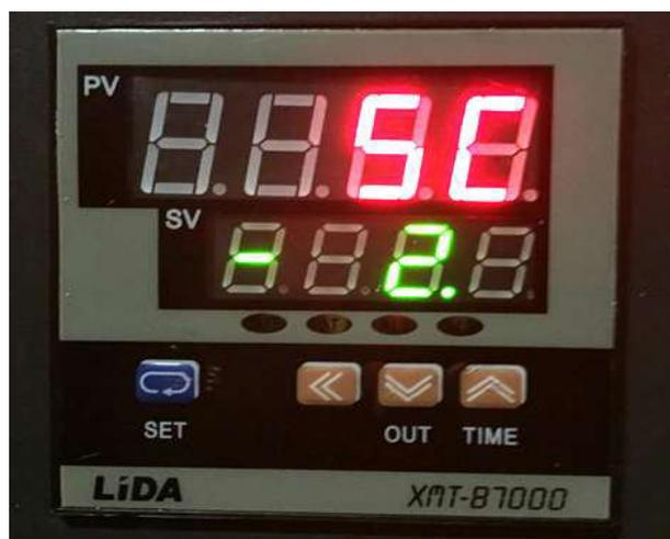
**Рис. 4. Установка параметра термоконтроллера SC**
